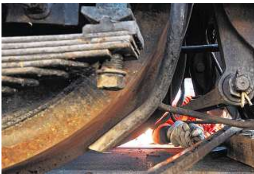
Ein Lokdrittel unterwegs: Eine «Schnauze» des Krokodils wird auf die Schienen gesetzt, dann gehts ans Lösen der eingerosteten Bremsen. Bilder Jano Felice Pajarola
